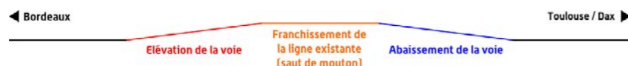
Schéma du franchissement de la ligne existante par la voie 1 [Source : Egis]
