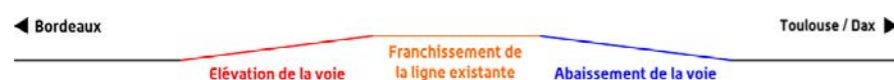
Schéma du franchissement de la ligne existante par la voie 1 (Source : Egis)
