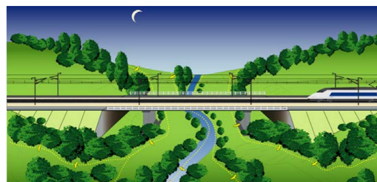
Amélioration de la transparence vis-à-vis des chauves-souris par aménagement de la structure de la végétation aux abords d'un viaduc (Source : Ecosphère)
