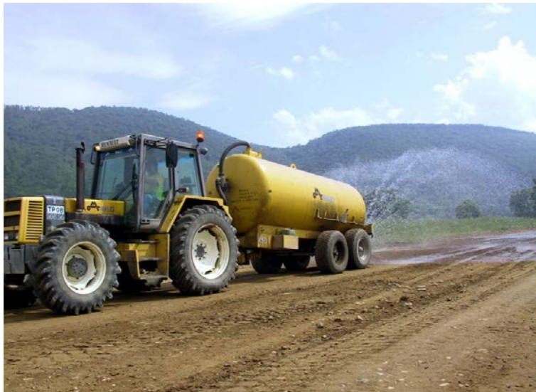
Arroseuse sur un chantier (Source : Egis)
