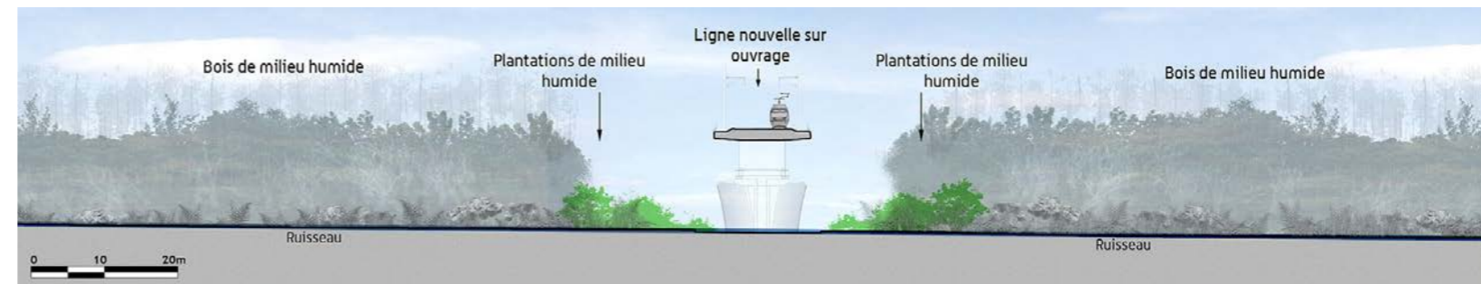
Coupe de principe des plantations de milieux humides au droit d'un franchissement de cours d'eau [Source : Egis, 2013]
