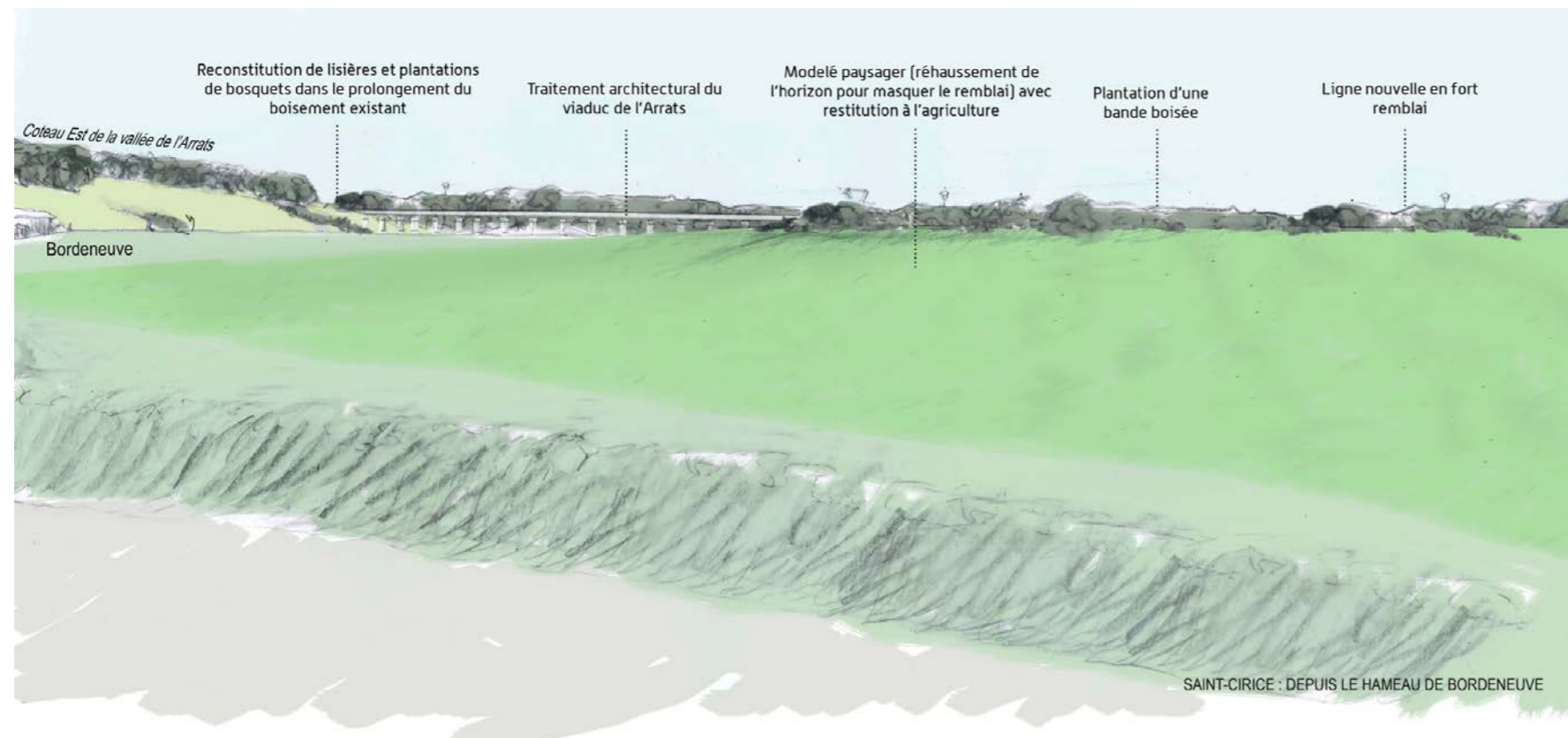
Croquis du traitement paysager de la zone de dépôt de la vallée de l'Arrats, depuis Bordeneuve [Source : Egis, 2012]
