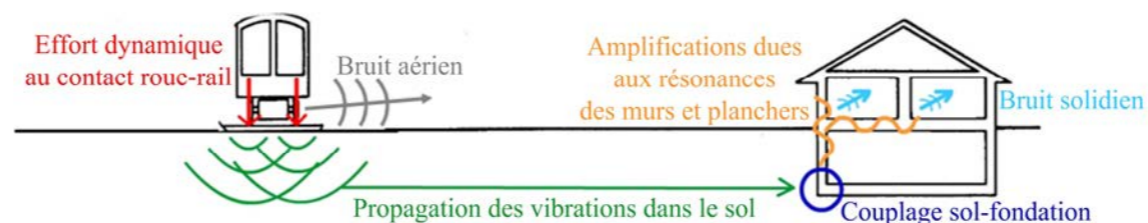
Bruit et vibrations dus au trafic ferroviaire [Source : D2S]
