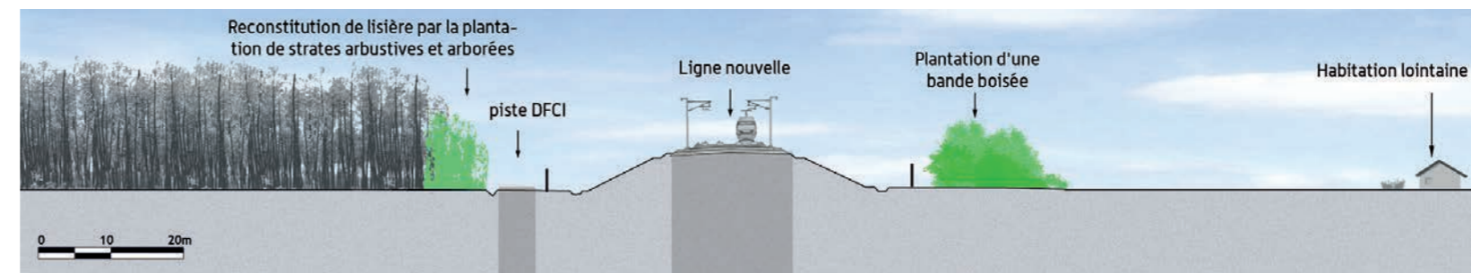
Coupe de principe pour le passage dans un aerial : plantation d'une bande boisée pour créer un masque visuel côté riverains. (Source : Egis, 2013)
