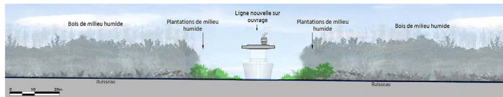
Coupe de principe du franchissement des milieux humides (à biodiversité écologique) du massif forestier landais [Source : Egis, 2013]
