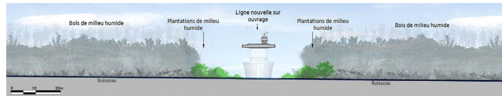
Coupe de principe du franchissement des milieux humides (d'une grande biodiversité) du massif forestier landais [Source : Egis, 2013]
