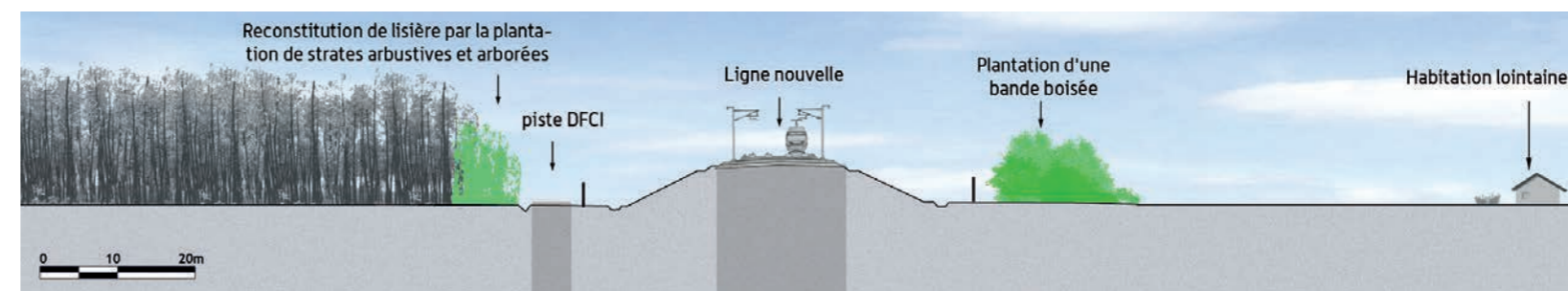
Coupe de principe pour la traversée et la coupure des airiaux et clairières agricoles habitées [Source : Egis, 2013]
