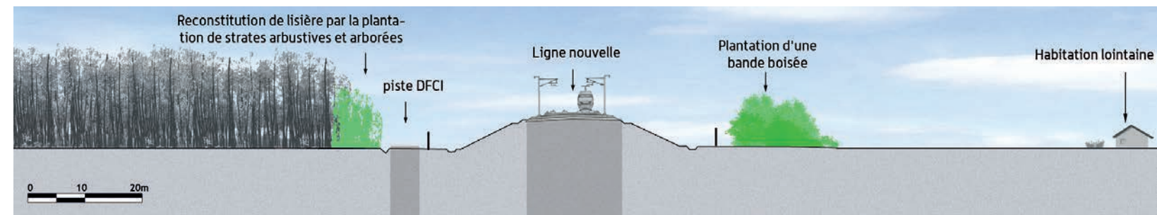
Coupe de principe pour la traversée et la coupure des airiaux (Source : Egis, 2013)
