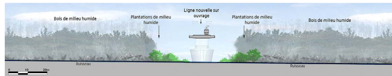
Coupe de principe du franchissement des milieux humides en ouvrage d'art [Source : Egis, 2013]
