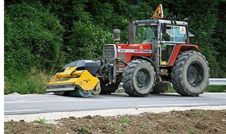
Tracteur nettoyant la chaussée [source : LCV Rhin – Rhône]
