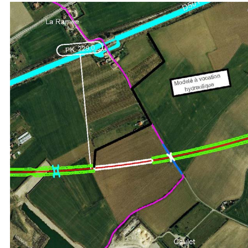
Principe d'implantation de la digue de protection de la Sarraillière
