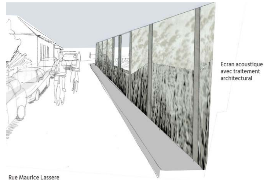
Rue Maurice Lasserre : projet avec traitement architectural de l'écran acoustique (Source : Egis, 2013)
