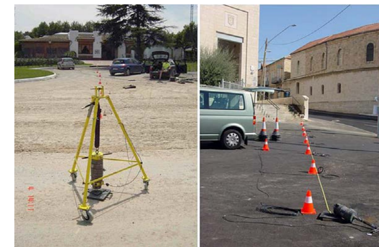
Dispositif de mesure de la transmissibilité linéaire du sol (Source : D2S, 2012)
