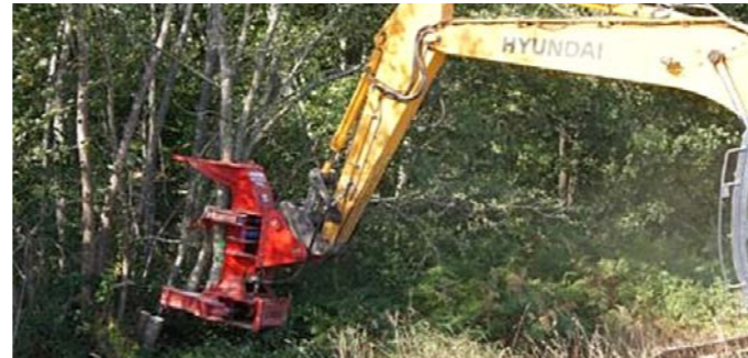
Abattage mécanique d'une ripisylve à 50 cm du sol minimum [P. Fournier - GREGE]
