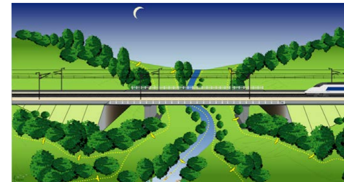
Amélioration de la transparence vis-à-vis des chauves-souris par aménagement de la structure de la végétation aux abords d'un viaduc (Source : Ecosphère)
