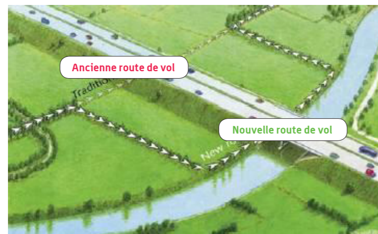
Principe de rétablissement des routes de vol des chauves-souris (d'après Limpens H.J.G.A., P. Twisk P. & G. Veenbaas, 2005)
