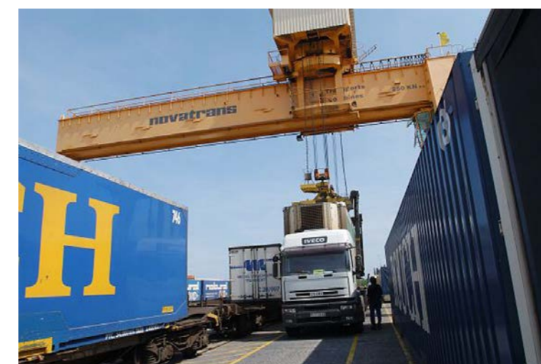
Plateforme de transport combiné du terminal Grand Saint-Charles, Perpignan : chargement conteneur sur wagon [Source : RFF / GIRAUD Philippe, 2003]
