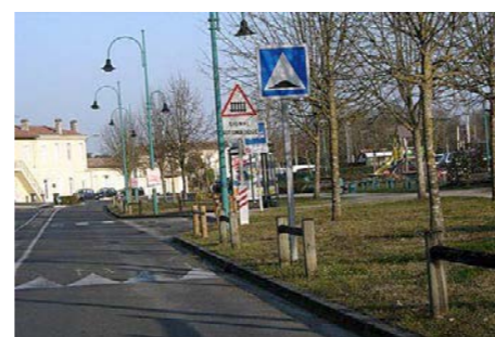
Panneaux d'annonce du PN peu mis en avant (source : CETE Sud-Ouest)
