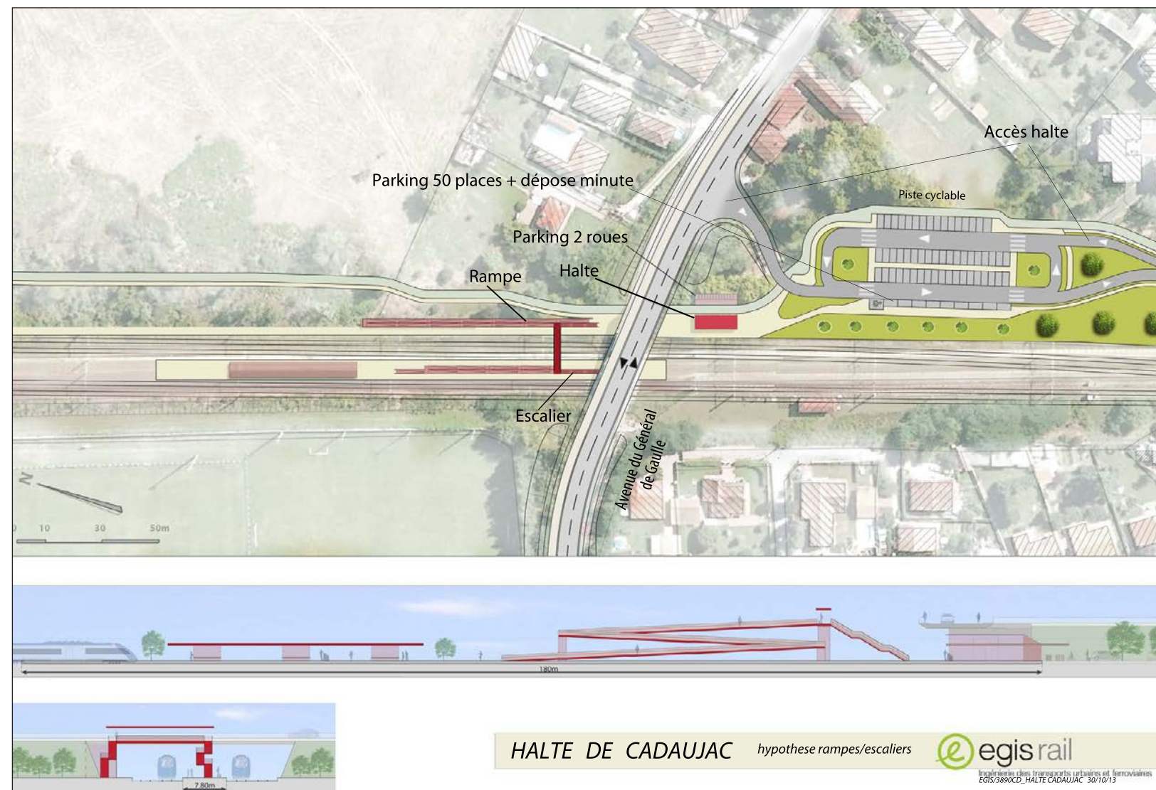
Modélisation de l'aménagement de la halte de Cadaujac : vue en plan et coupe transversale (Source : Egis, 2012)
